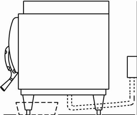
LOCATE ELECTRIC BOX AS CLOSE TO STERILIZER AS POSSIBLE AND PER LOCAL ELECTRIC CODES.
